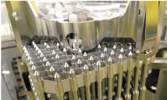
Ausgeliefertes Brennelement mit gedrucktem Kopfgitter (März 2022).
